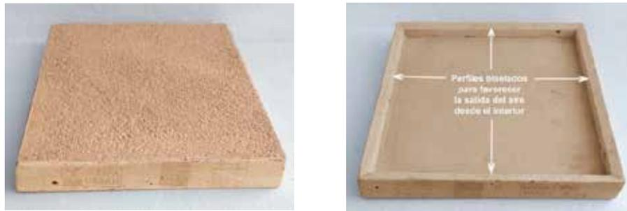
**Fig. 5.** Tapadera, exterior superficie rugosa, interior lisa
